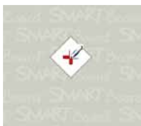
Prawidłowy punkt orientacji Pióro dotyka środka wskaźnika kalibracyjnego.
